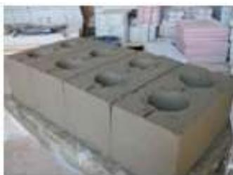
Рядовой блок с 2 круглыми пустотами размером блока 390х190х190мм.
